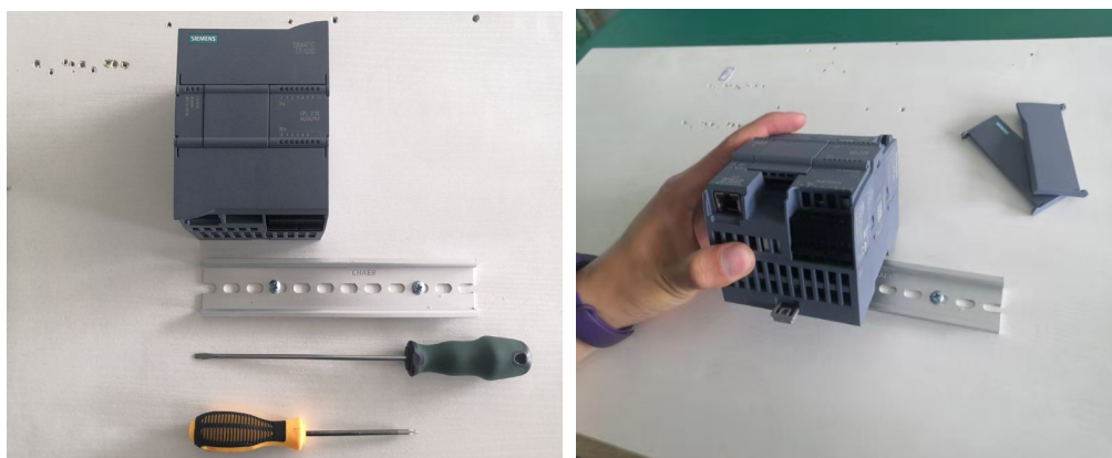
图 1-4 S7-1200 CPU 模块安装示意
